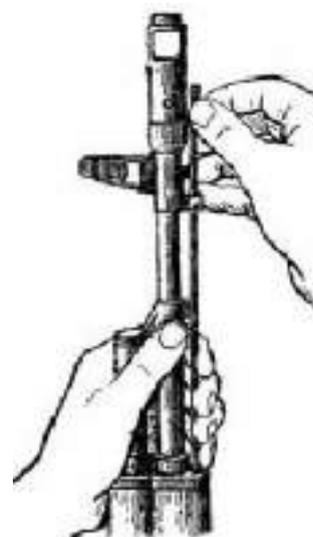
У АКС74У вынуть из сумки шомпол и пенал принадлежности; раскрыть пенал и вынуть из него протирку, ершик, отвертку и выколотку.
