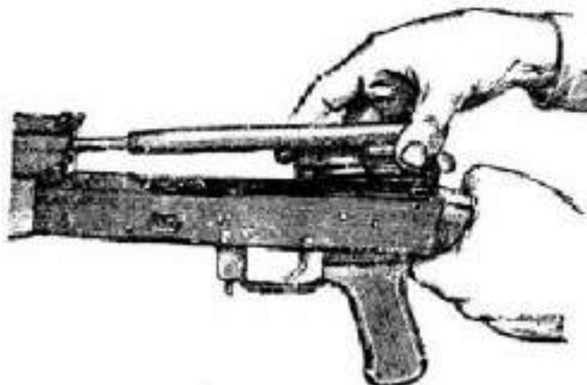
7) Отделить затворную раму с затвором. Продолжая удерживать автомат (пулемет) левой рукой, правой отвести затворную раму назад до отказа, приподнять ее вместе с затвором и отделить от ствольной коробки.
