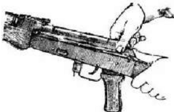
5) Отделить крышку ствольной коробки.левой рукой обхватить шейку приклада, большим пальцем этой руки нажать на выступ направляющего стержня возвратного механизма, правой рукой приподнять вверх заднюю часть крышки ствольной коробки и отделить крышку.
