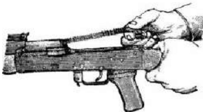
6) Отделить возвратный механизм. Удерживая автомат левой рукой за шейку приклада, правой подать вперед направляющий стержень возвратного механизма до выхода его пятки из продольного паза ствольной коробки; приподнять задний конец направляющего стержня и извлечь возвратный механизм из канала затворной рамы.
