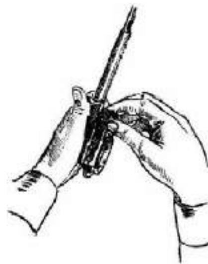
9) Отделить газовую трубку со ствольной накладкой. Удерживая автомат (пулемет) левой рукой, правой поднять замыкатель газовой трубки, повернуть замыкатель газовой трубки от себя до положения в 45 градусов и снять газовую трубку со ствольной накладкой с патрубком газовой камеры.
