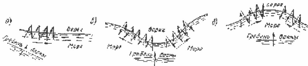
**Схема движения наносов**
